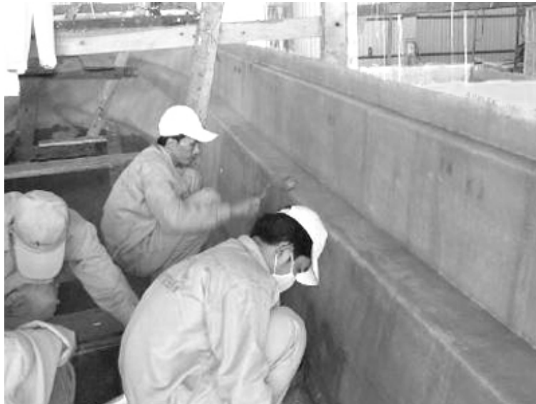
Hình 7. Dán khung sườn vào vỏ tàu
