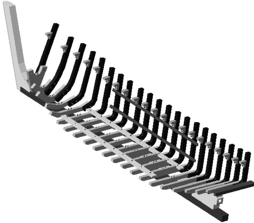
Hình 1.6.1.Kết cấu một khung dàn đáy và mạn tàu
